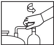
Ventil der Treibgasflasche öffnen.
